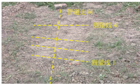
图 14 1 m 埋深 PE 管定位测试
