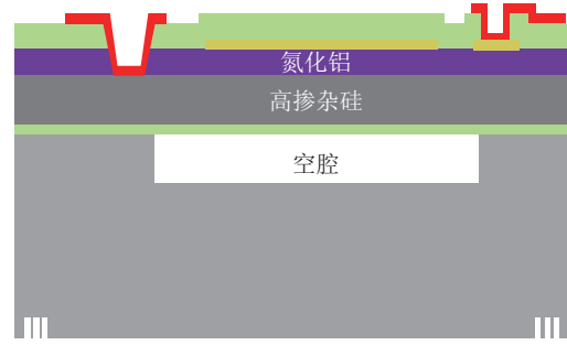
图 1 PMUT 横截面结构示意图
