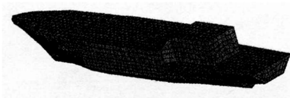
图 3 X 型艇声学边界元模型
