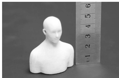
图 3 3D 打印的缩尺人工头模型
